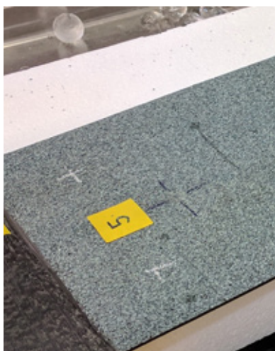
Prova su supporto morbido secondo VKF Test Protocol n° 09.
