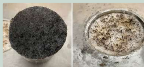
Fig. 1 Test di adesione al calcestruzzo - DIN EN 1348
