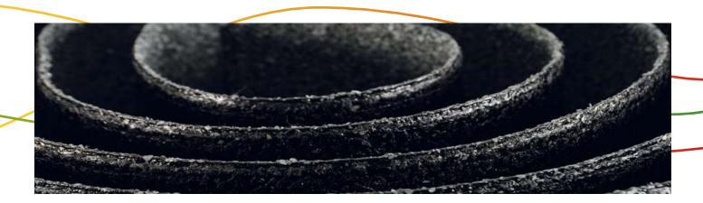
combustione per la produzione energia termica. La compattezza del materiale e la stabilità chimica e biologica di **Genetherm**, rendono questo isolante sicuro poiché, per le sue caratteristiche, non costituisce un pericolo per l'igiene ambientale e per le falde acquifere. Infatti non può essere assorbito dal terreno, né disciolto in acqua o immesso allo stato di vapore nell'ambiente circostante. Inoltre, poiché atossico ed inerte, non rilascia alcun tipo di gas ed è quindi assolutamente sicuro.
