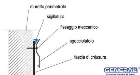
Fig. 16 – coronamento superiore di risvolto verticale: soluzione con profilo metallico a gocciolatoio
