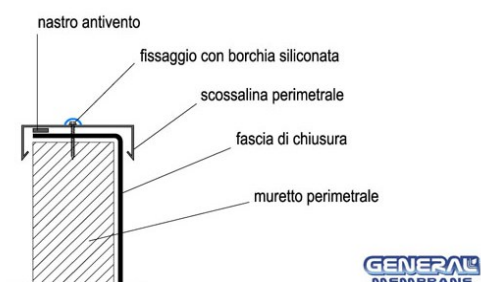
Fig. 22 - coronamento superiore di risvolto verticale: soluzione con lattonerie conformata alla testa del muretto
