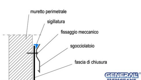
Fig. 21 – coronamento superiore di risvolto verticale: soluzione con profilo metallico a gocciolatoio
